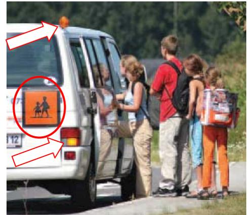
aus dem gekennzeichneten Schulbus sind die Warnblinkanlage und die zusätzlich gelbroten Warnleuchten am Schulbus zu verwenden.
